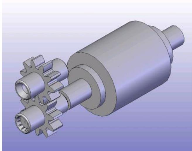
Fig. 2.12.Rotor Pinion/gear assembly
